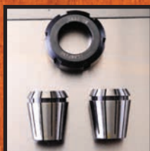
Сменные цанги на 8 мм и 12 мм для концевых фрез
