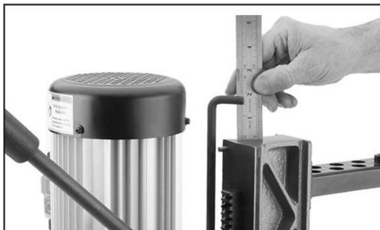
Рисунок 22. Регулировка ограничителя глубины с помощью линейки.
