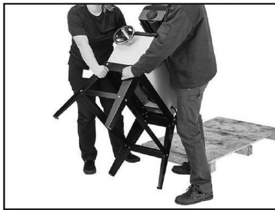
Рисунок 11. Наклоните шлифовальную машину вертикально.
