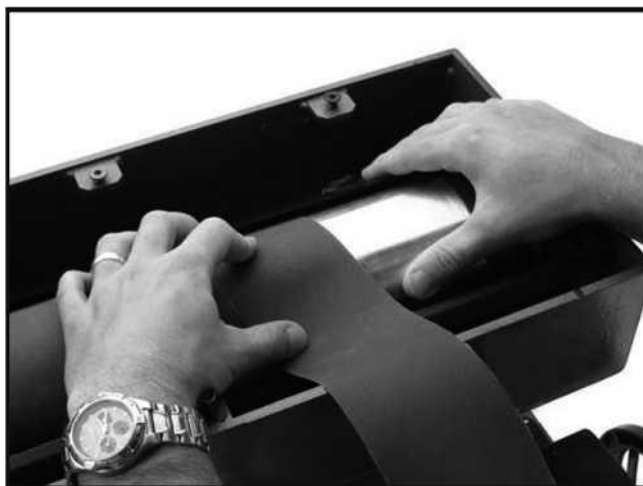
Рисунок 22. Обертывание барабана наждачной бумагой.
