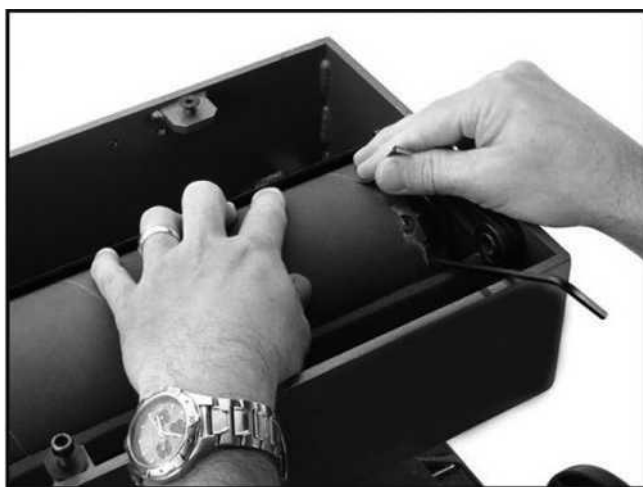
Рисунок 24. Наматываем абразивную ленту на натяжной круг.
