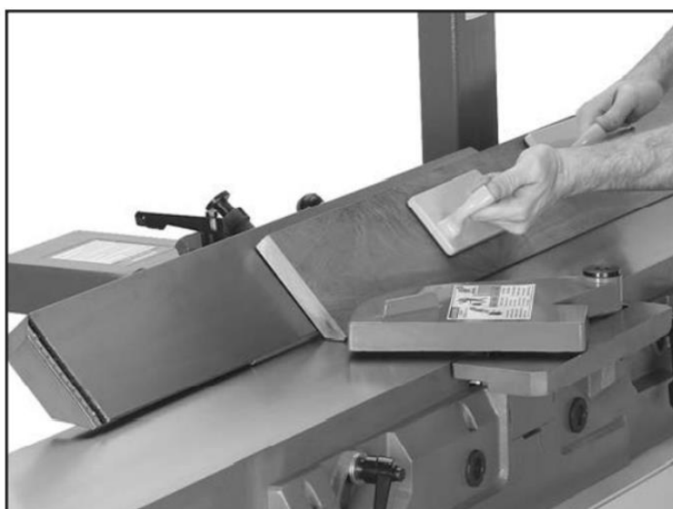
Рисунок 39. Пример установки ограждения для выполнения скоса под углом 45°.
