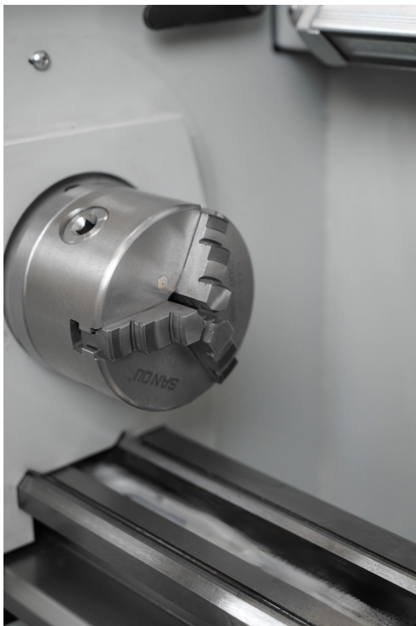
На станке установлен 3-х кулачковый патрон диаметром 100 мм.
