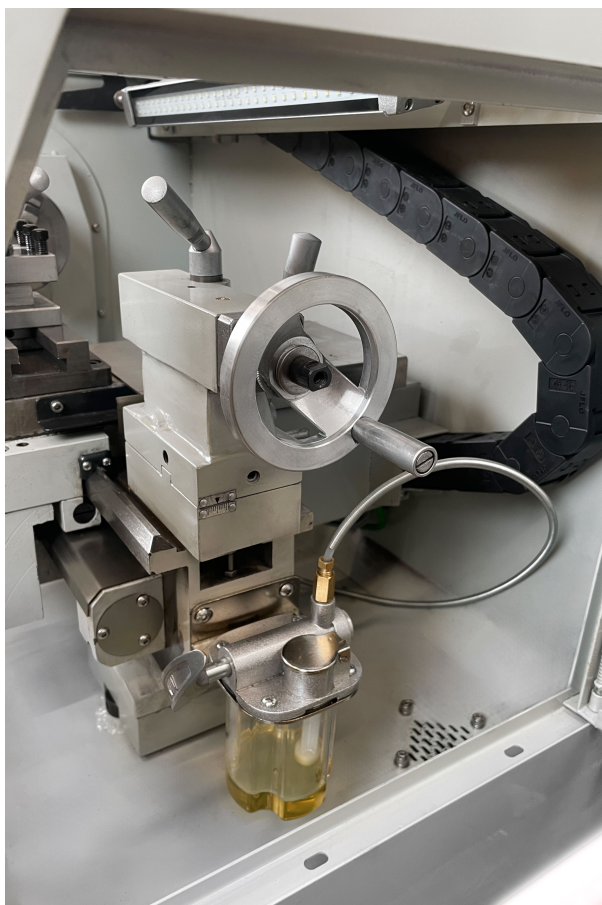
Перемещение задней бабки осуществляется вручную.
