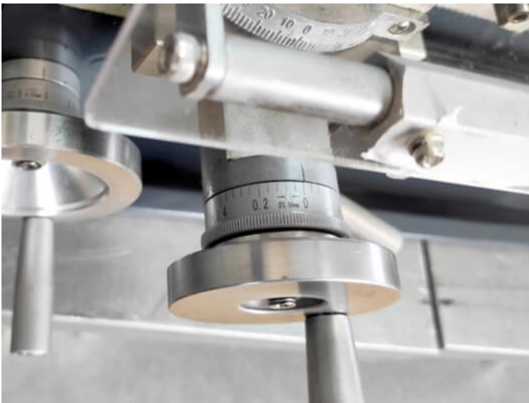
Цена деления лимба поперечной подачи – 0,04 мм.
