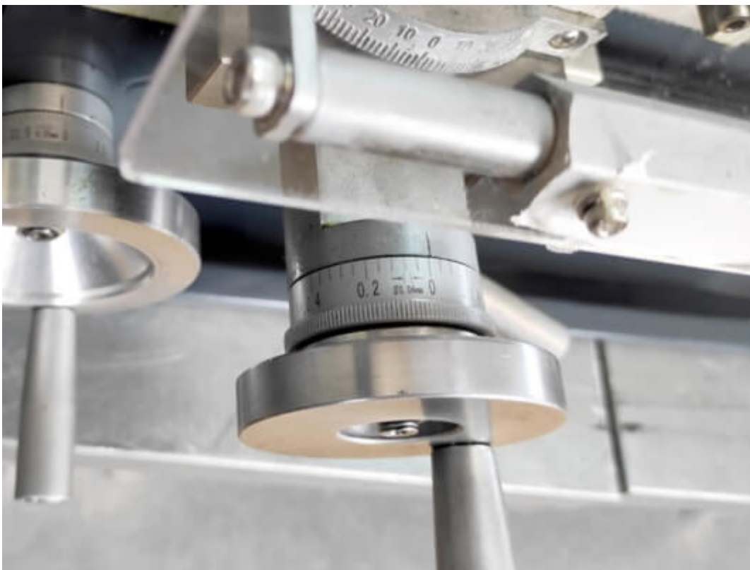
Цена деления лимба поперечной подачи – 0,04 мм.
