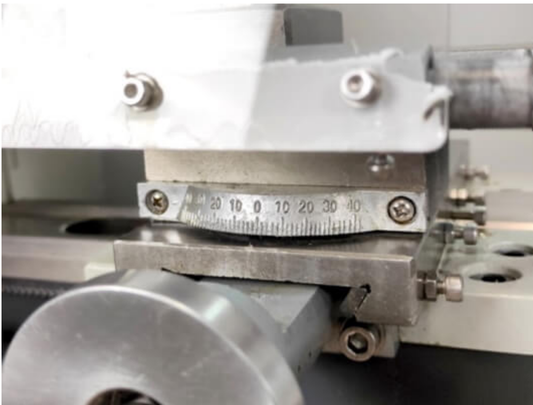
Наличие шкалы для определения угла поворота резцедержателя.
