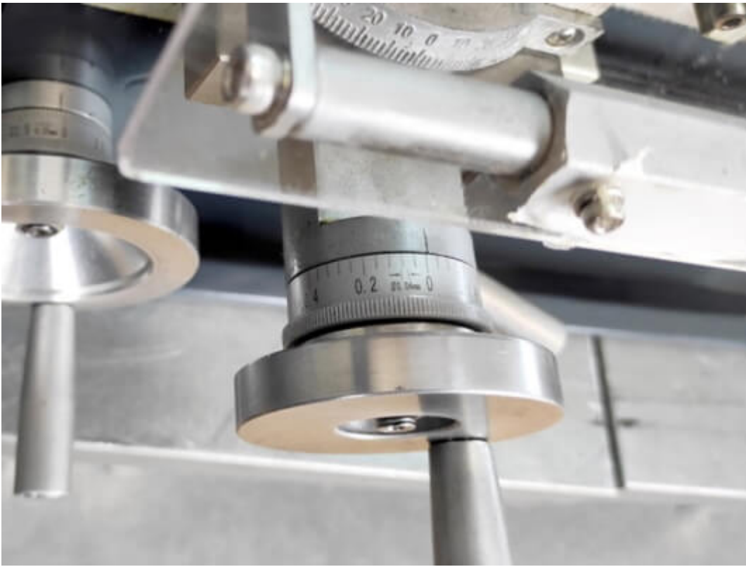
Цена деления лимба поперечной подачи – 0,04 мм.
