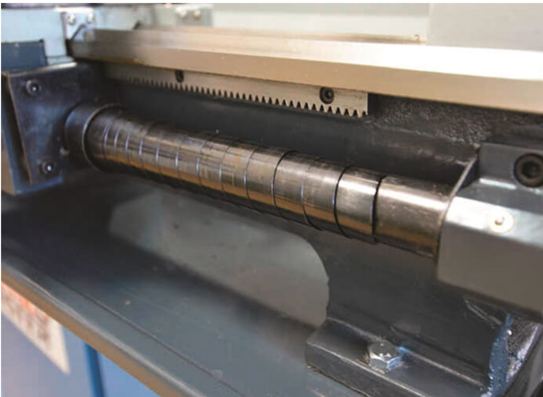
Телескопическая защита ходового винта от стружки эффективно защищает ходовой винт от износа.
