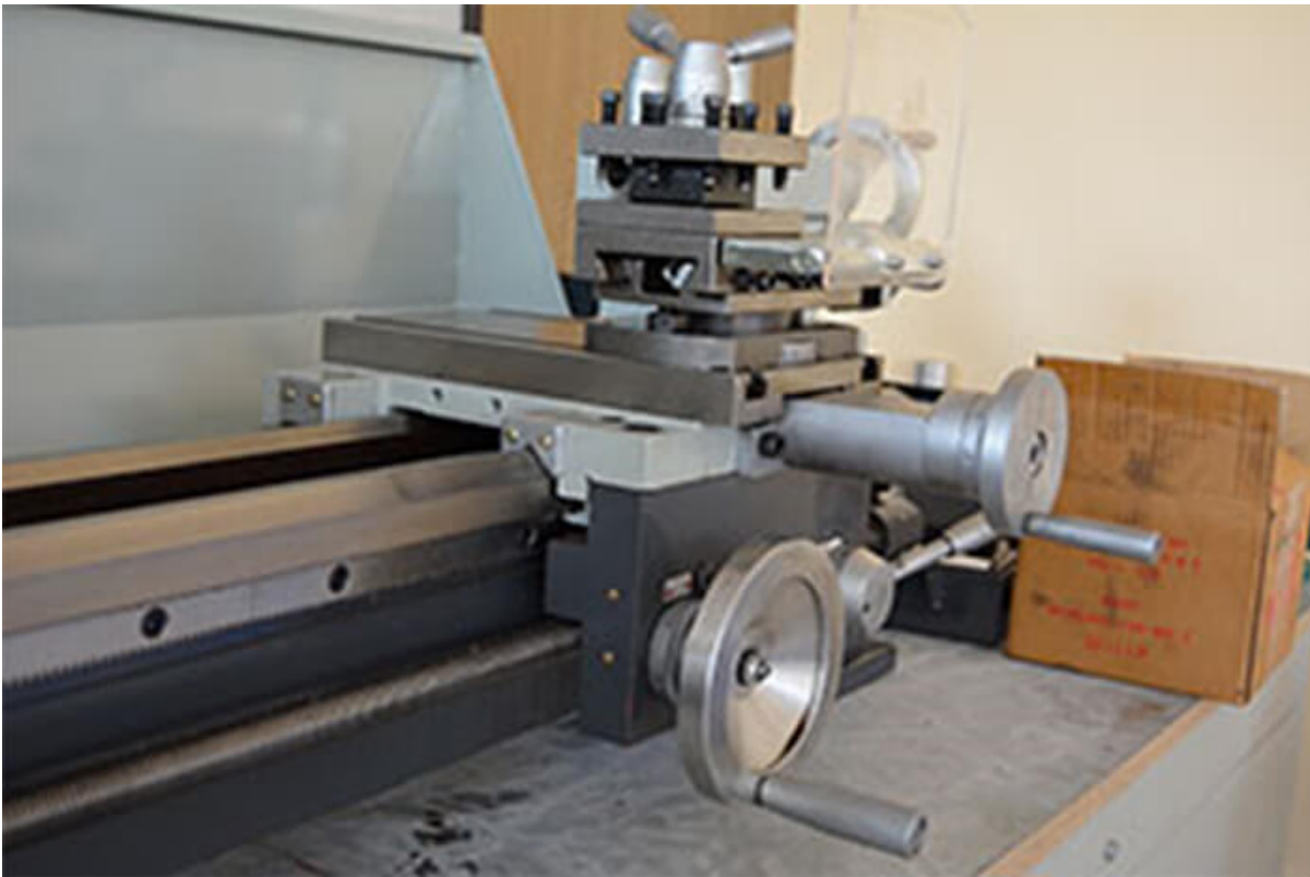
Металлические маховики продольной и поперечной подачи.
