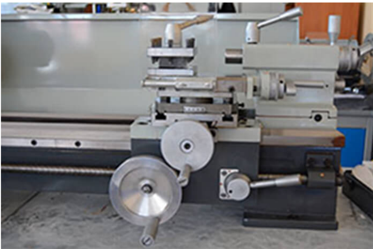
Усиленный суппорт шириной 150мм и Т-пазами
