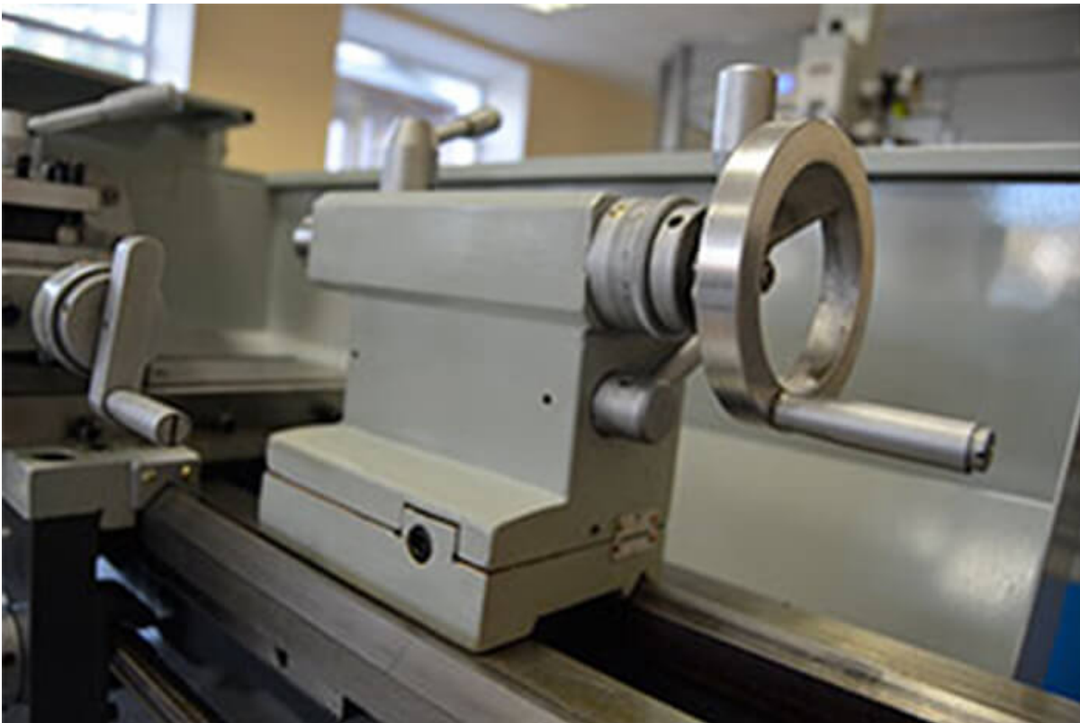
Массивная задняя бабка с основанием 150мм и быстрым зажимом.
