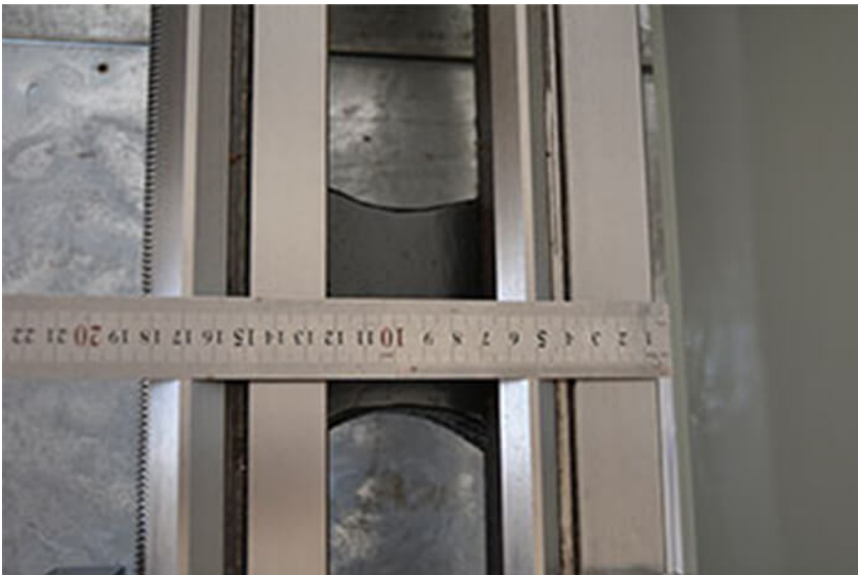
Закаленная станина шириной 180 мм
