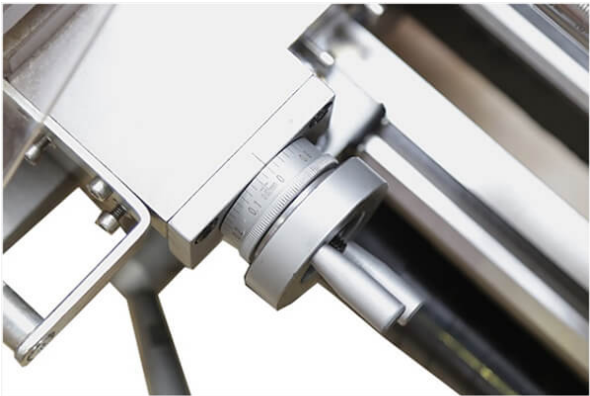
Цена деления лимба тонкой продольной подачи - 0.02 мм
