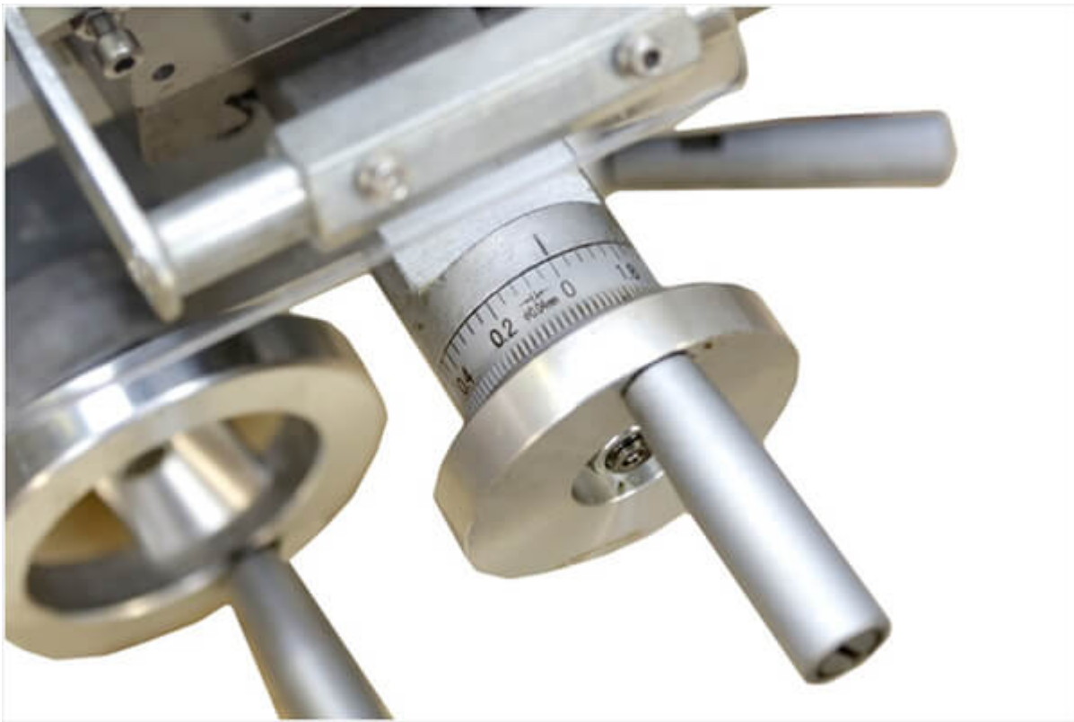
Цена деления лимба поперечной подачи – 0,04 мм.
