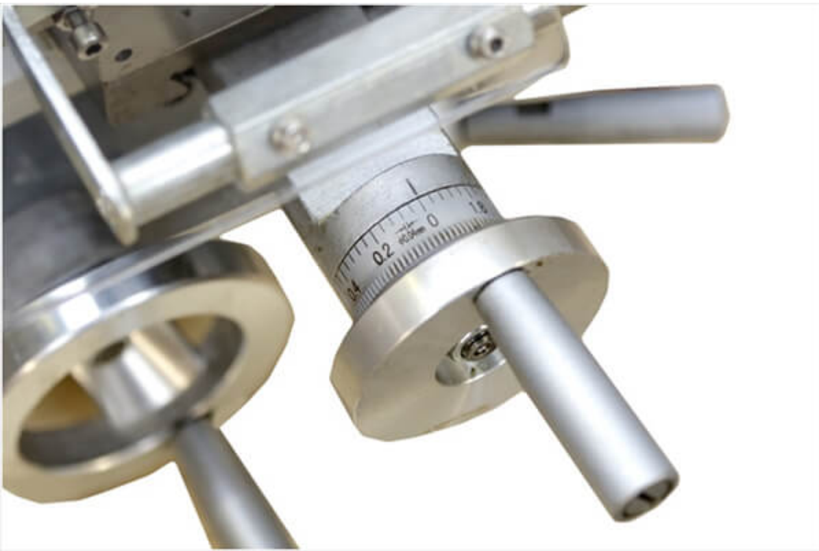
Цена деления лимба поперечной подачи – 0,04 мм.
