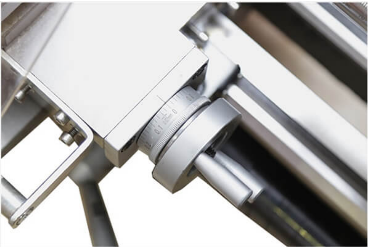
Цена деления лимба тонкой продольной подачи - 0.02 мм
