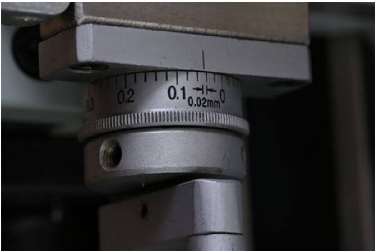
Цена деления лимба тонкой продольной подачи - 0.02 мм
