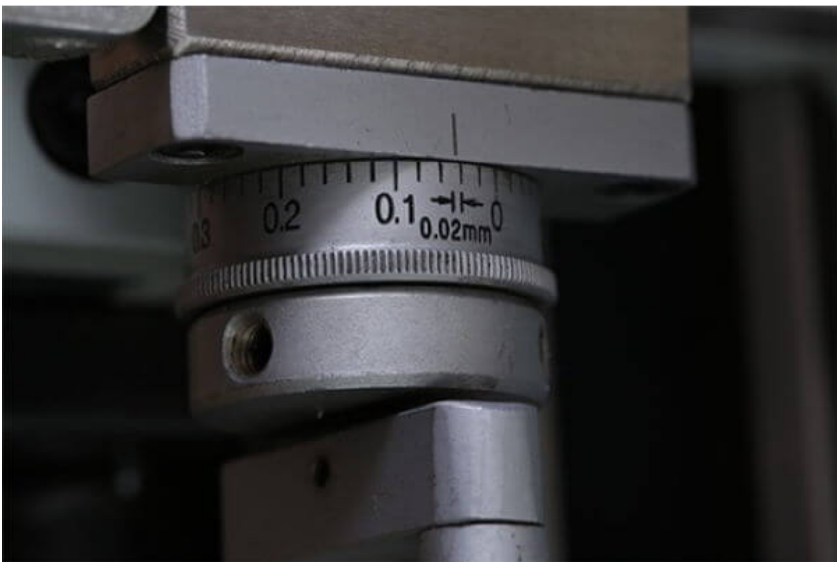
Цена деления лимба тонкой продольной подачи - 0.02 мм
