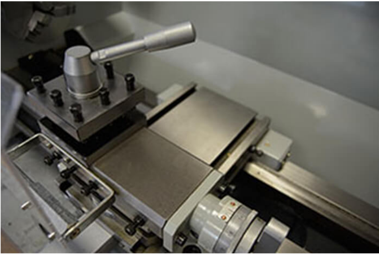
Расстояние между центрами пазов-115мм.
