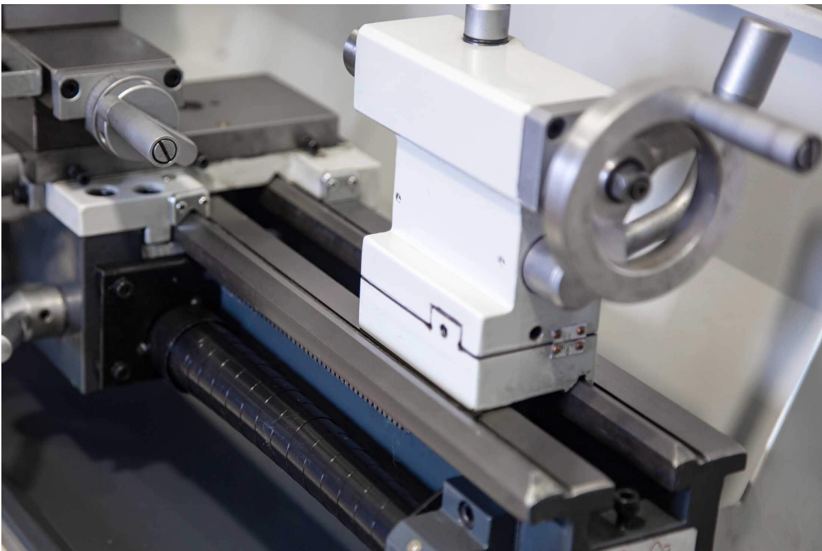
Направляющие станка прошли закалку ТВЧ (48-52 HRC) и шлифовку, что способствует повышению уровня надежности и точности обработки детали.
