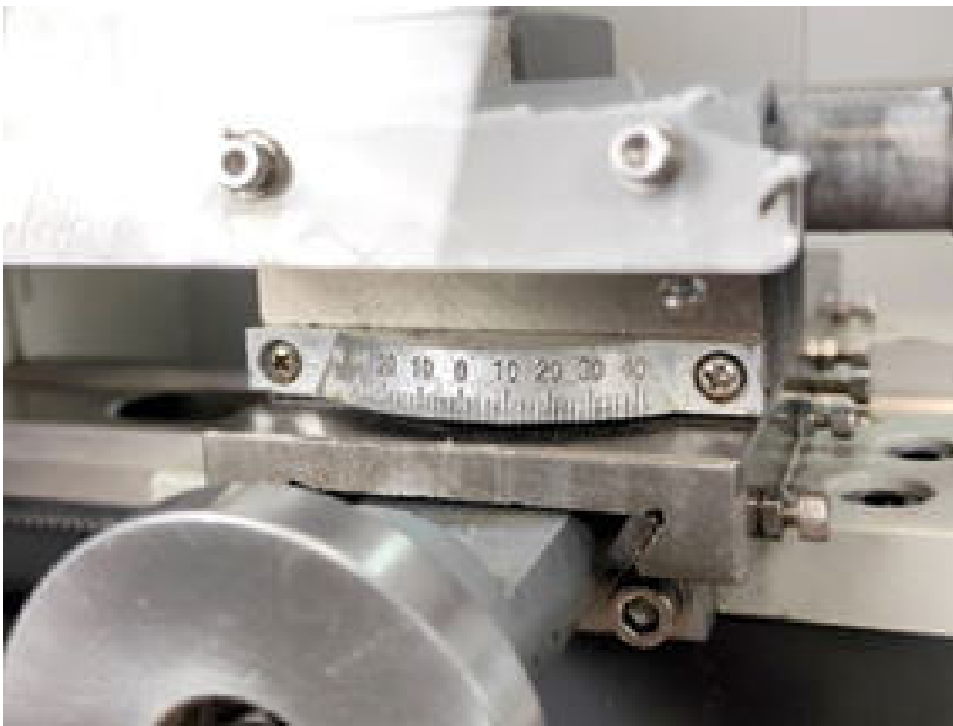
Наличие шкалы для определения угла поворота резцедержателя.
