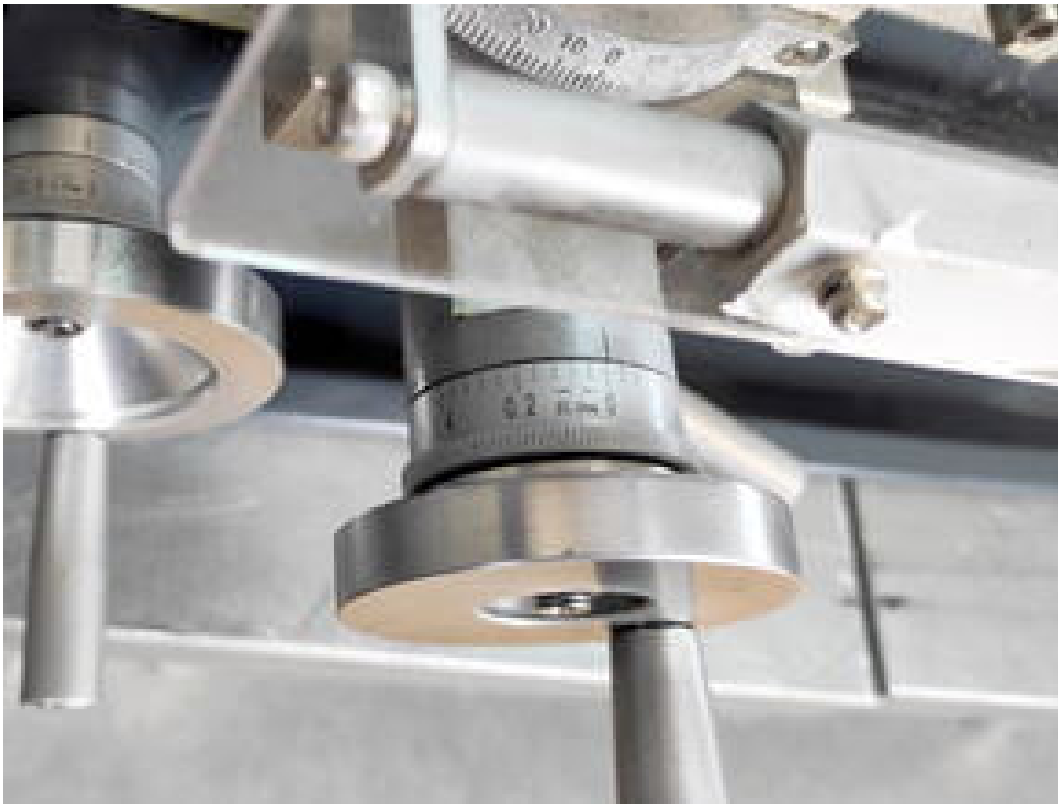
Цена деления лимба поперечной подачи – 0,04 мм.
