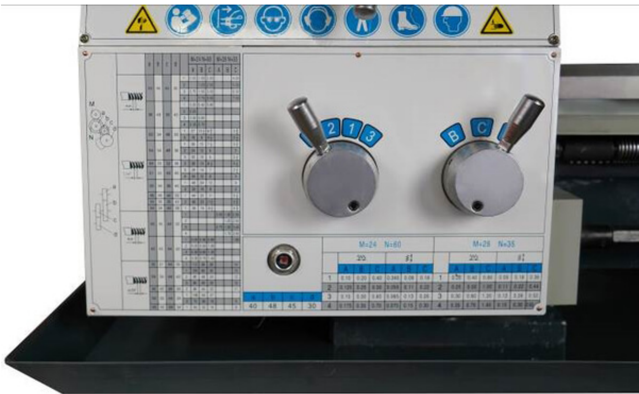
Станок Metal Master MasterTurn 3660G имеет удобную и понятную таблицу резьб и подач.
