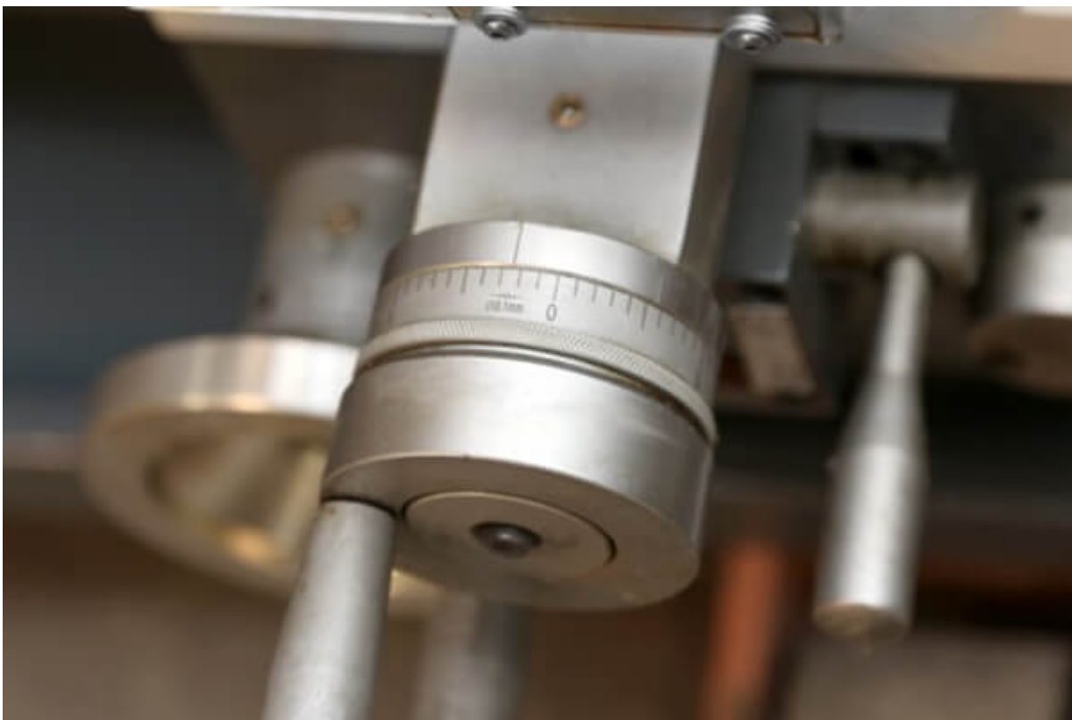
Цена деления лимба поперечной подачи – 0,1мм.
