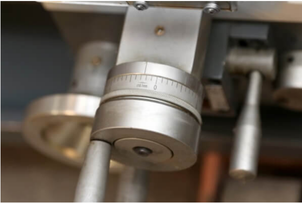
Цена деления лимба поперечной подачи – 0,1мм.
