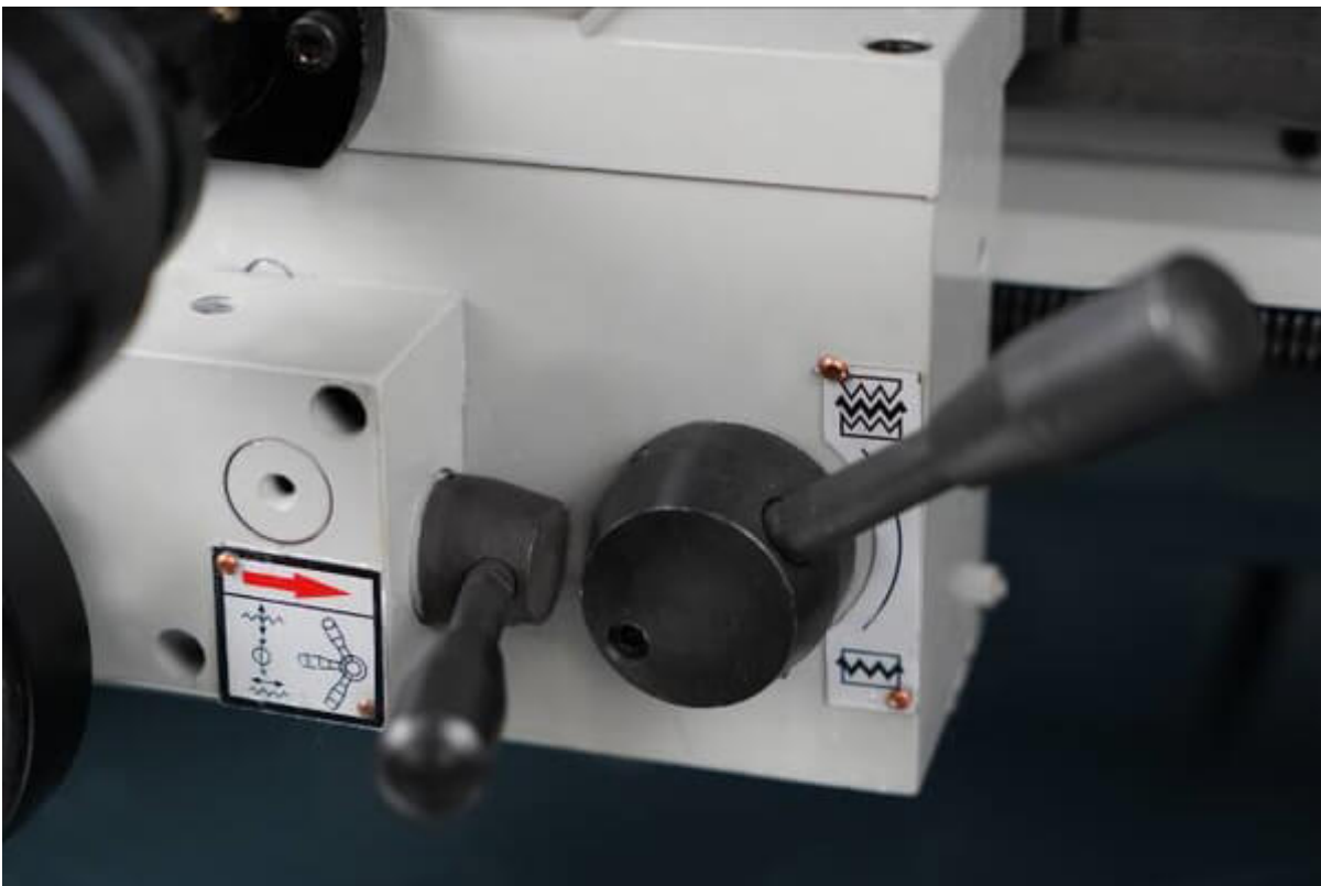
Токарный станок оснащен механизмом продольной и поперечной автоподачи.
