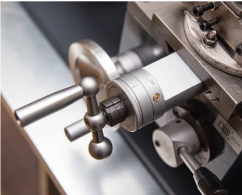
Цена деления лимба поперечной подачи – 0,1мм.
